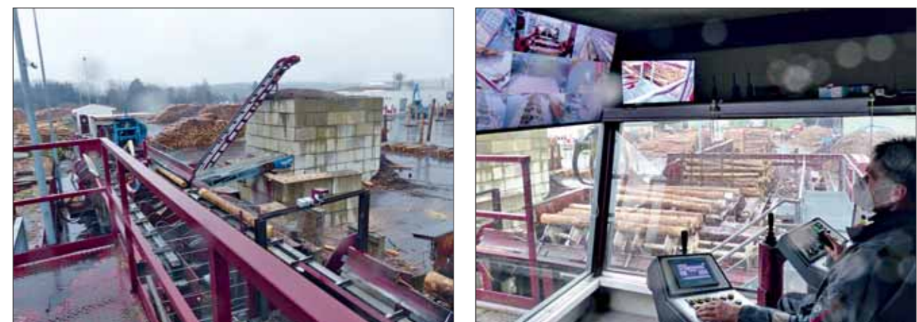
1,4 Mio. Stammschnitte wurden 2021 über den Rundholzplatz gefahren, um 102 000 Fm für den Einschnitt bereitzustellen.
