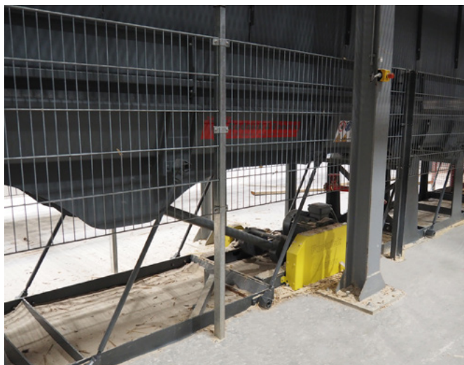
Für den Spreißeltransport in Richtung des Hackers setzt Rudnick & Enners auf energieeffiziente Resonanzförderrinnen
