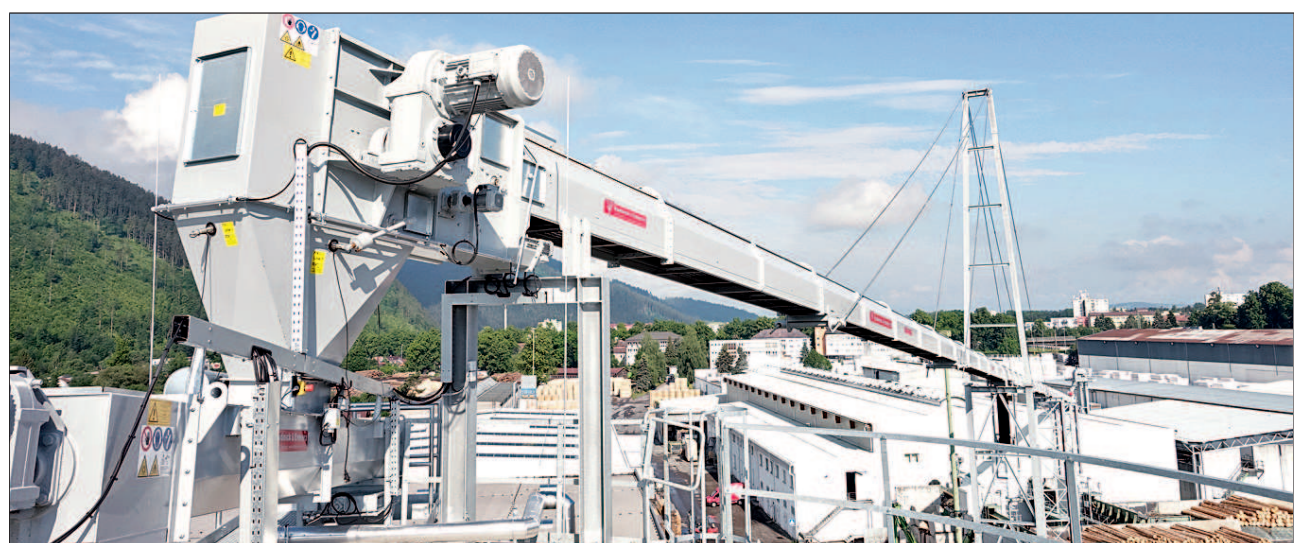
Das Material aus dem Sägewerk wird per Rohrgürtelförderer zur Pelletierung transportiert.
