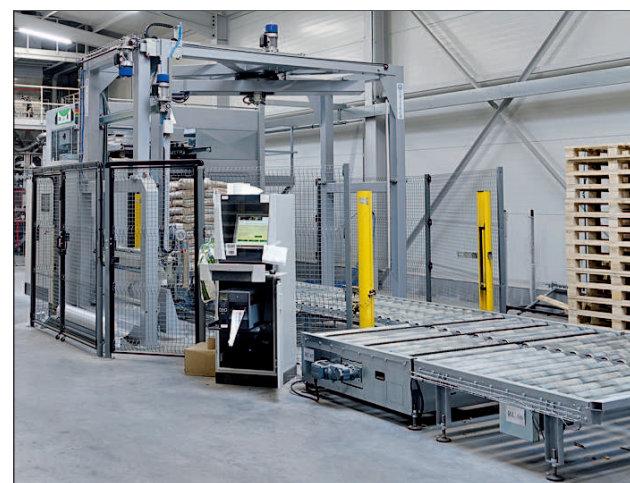
Rudnick und Enners lieferte auch die Absackanlage, die auf 15 kg-Säcke ausgelegt ist, was jedoch variiert werden kann.
