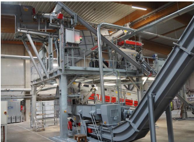
Kompakte, aber leistungsfähige Anlage: oben die Pelletspresse, unten die Kühlung und Vibrator in den Silo
